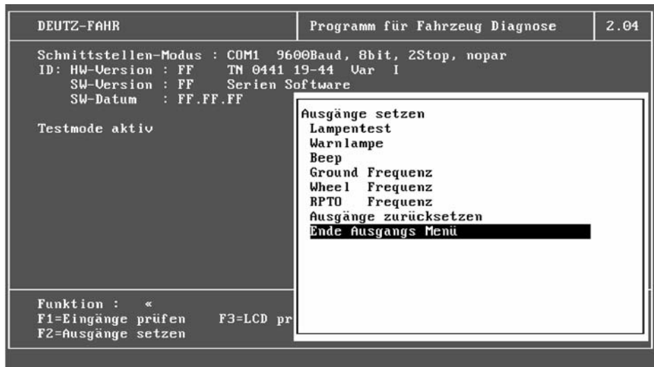
Fig. 57 - Fenêtre Set outputs
